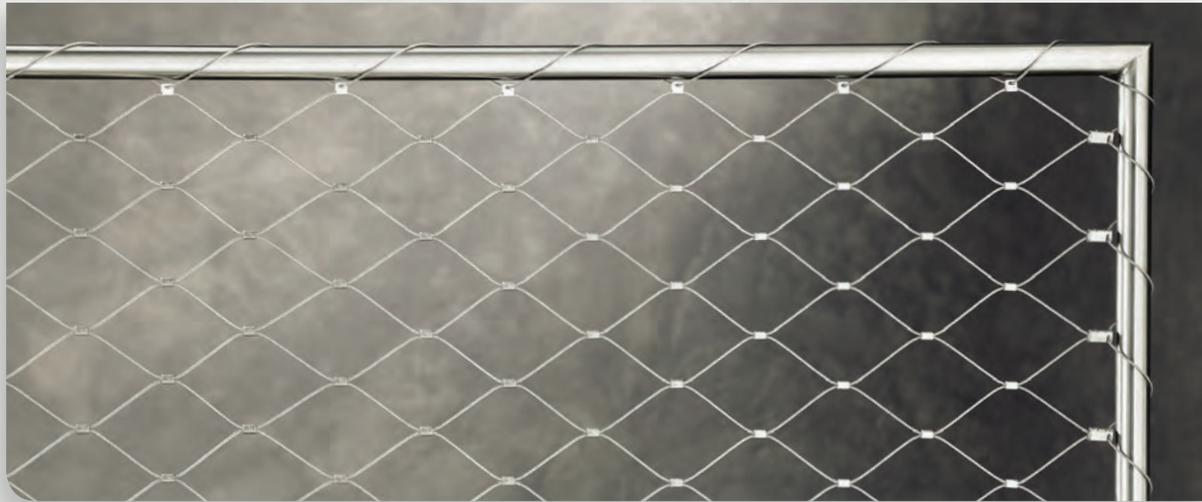
X-TEND Edelstahlnetze sind leicht, lichtdurchlässig und robust. Bei der Fertigung der Netze werden hochwertige Edelstahlseile und Presshülsen zu einer belastbaren und flexiblen Struktur verknüpft. Die gegenseitige Krümmung der Edelstahlseile bewirkt die überaus robuste Beschaffenheit von X-TEND. Damit hält das Netz selbst starken Belastungen stand.
